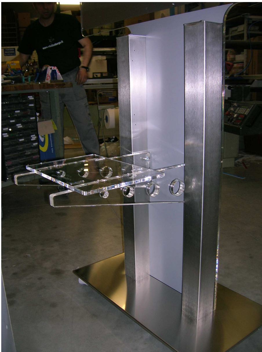
Particolare del sistema di supporto del videoproiettore NEC WT610
